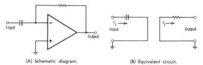
Fig. 1-8. Differentiator circuit.
