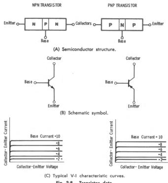
Fig. 2-8. Transistor data.
