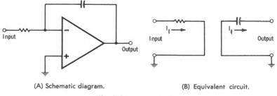
Fig. 1-7. Integrator circuit.
