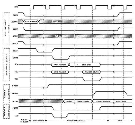
FIGURE 3. TYPICAL MASTER WRITE CYCLE
