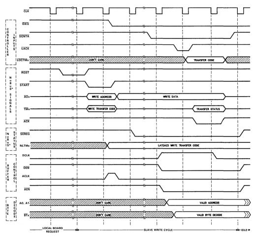
FIGURE 9. TYPICAL SLAVE WRITE CYCLE
