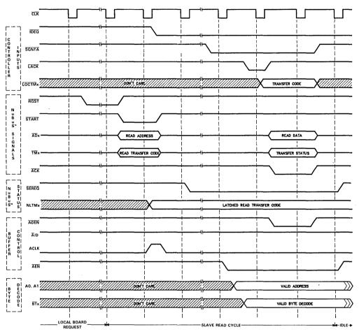
FIGURE 8. TYPICAL SLAVE READ CYCLE
