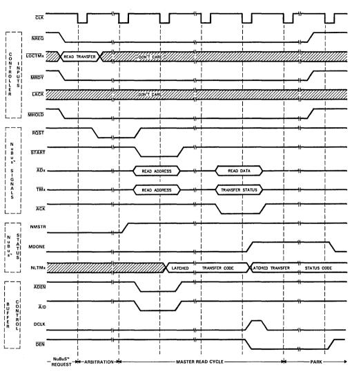
FIGURE 2. TYPICAL MASTER READ CYCLE
