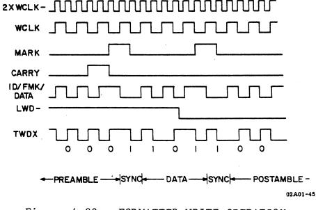
Figure 4-23. FORMATTER WRITE OPERATION
