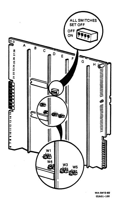
Figure B-1. FORMATTER MODULE - CONFIGURATION SELECTION COMPONENTS
