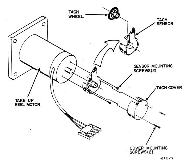
Figure 5-8. TAKE-UP REEL DISASSEMBLY
