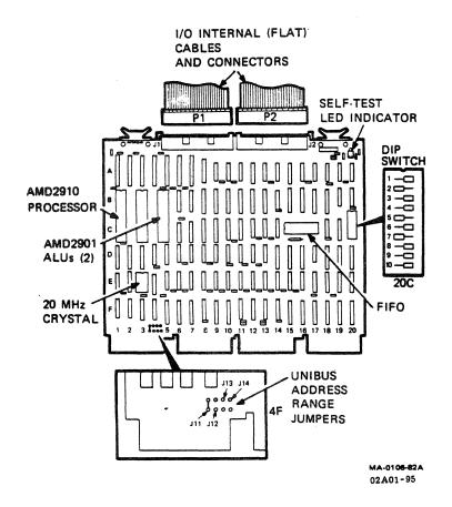
Figure A-2. M7454 UNIBUS ADAPTER MODULE
