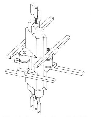
Figure 6—Latching crosspoint element of Le Matériel Téléphonique using 3 type H 50 reed contacts.
