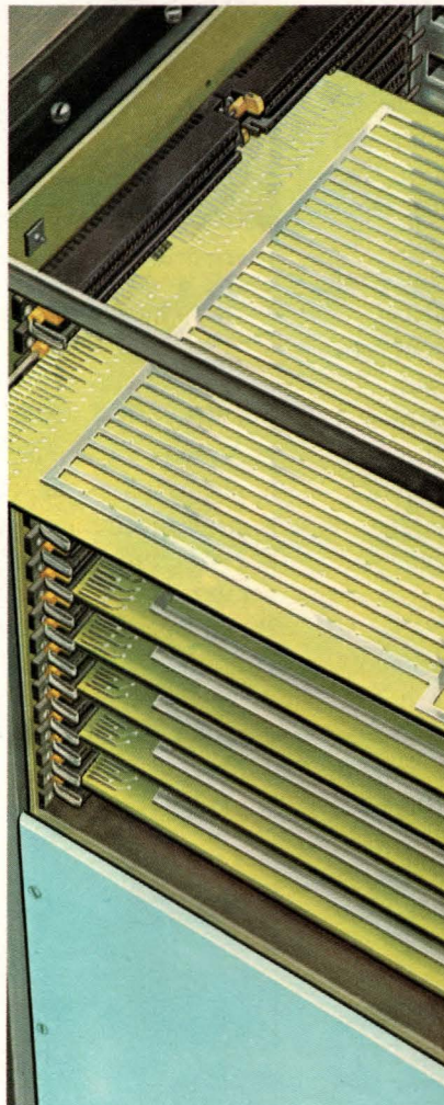
2. ZIF Connectors replace card guides
