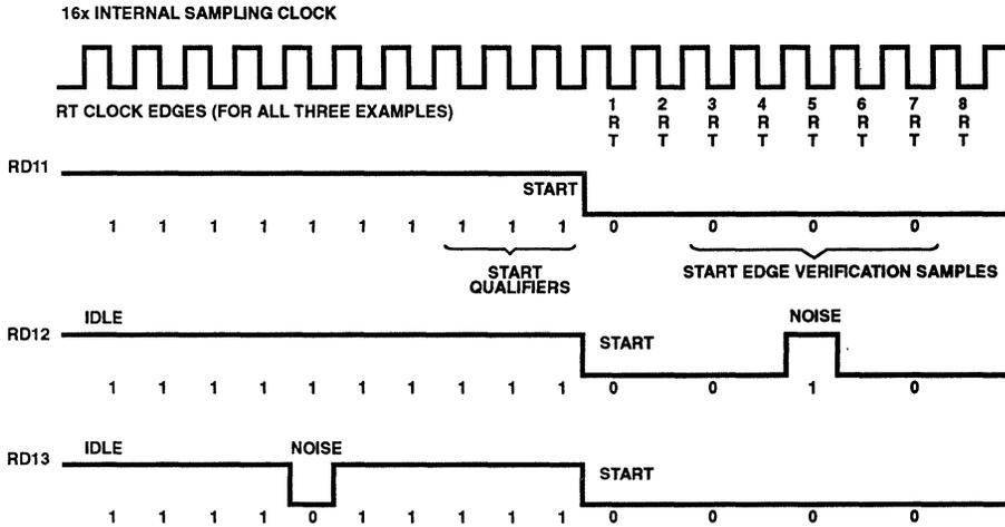
FIGURE 21. EXAMPLES OF START BIT SAMPLING TECHNIQUE
