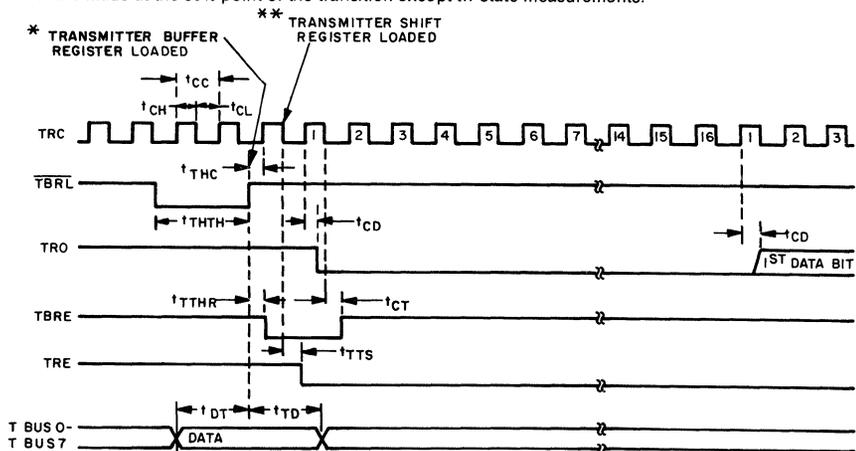
\* THE HOLDING REGISTER IS LOADED ON THE TRAILING EDGE OF  $\overline{\text{TBRL}}$
