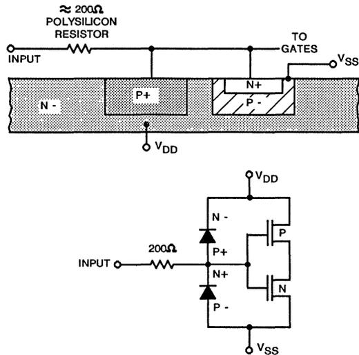
**FIGURE 2. JUNCTION ISOLATED DUAL DIODE PROTECTION NETWORKS ARE MOST COMMONLY USED IN TODAY'S CMOS CIRCUITS**
