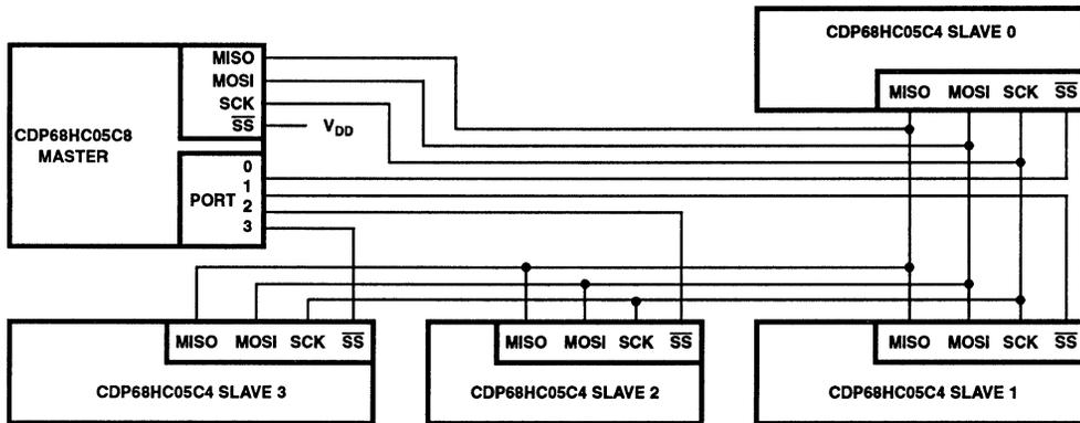
FIGURE 27. MASTER-SLAVE SYSTEM CONFIGURATION (SINGLE MASTER, FOUR SLAVES)
