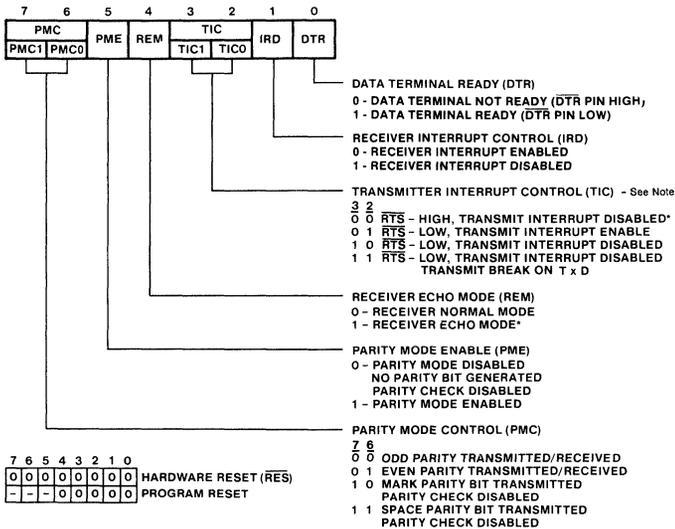
\* BITS 2 AND 3 MUST BE ZERO FOR RECEIVER ECHO MODE. RTS WILL BE LOW.
