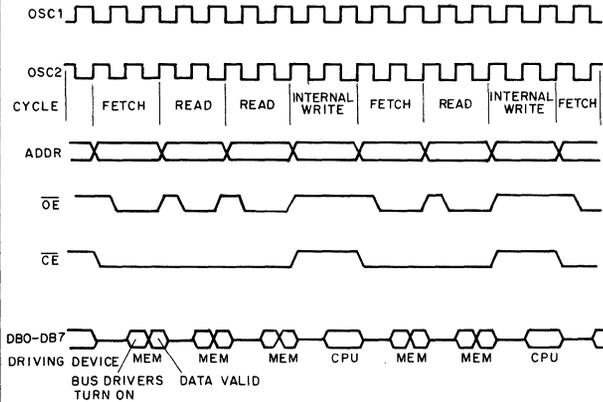
**FIGURE 2. TYPICAL CYCLE TIMING FOR THE CDP68EM05D2 EMULATOR.**
