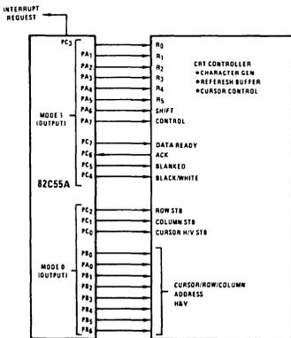
**FIGURE 22. BASIC CRT CONTROLLER INTERFACE**
