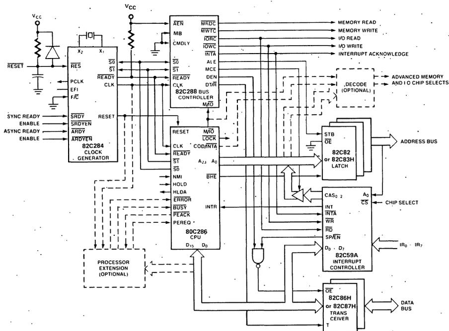
FIGURE 31. BASIC 80C286 SYSTEM CONFIGURATION
