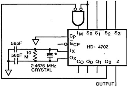
**FIGURE 3. 19200 BAUD OPERATION**
