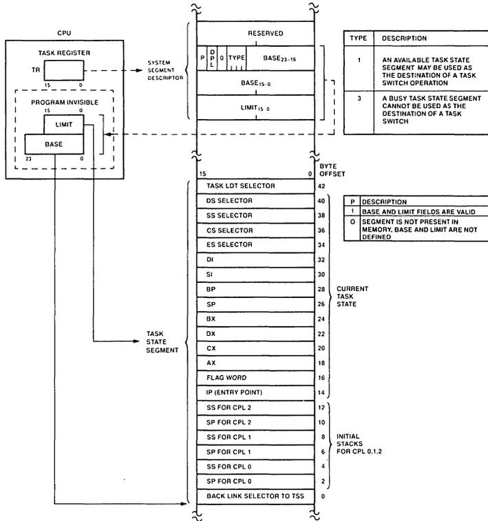
**FIGURE 19. TASK STATE SEGMENT AND TSS REGISTERS**
