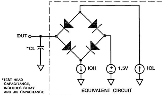
\*TEST HEAD CAPACITANCE, INCLUDES STRAY AND JIG CAPACITANCE
