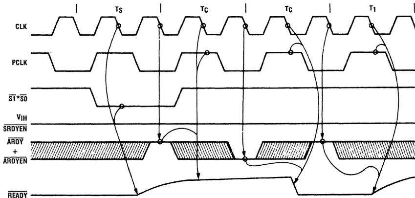
FIGURE 6. ASYNCHRONOUS READY OPERATION
