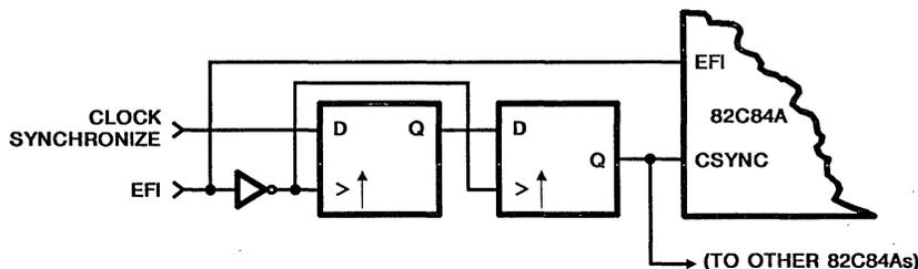
FIGURE 1. CSYNC SYNCHRONIZATION
