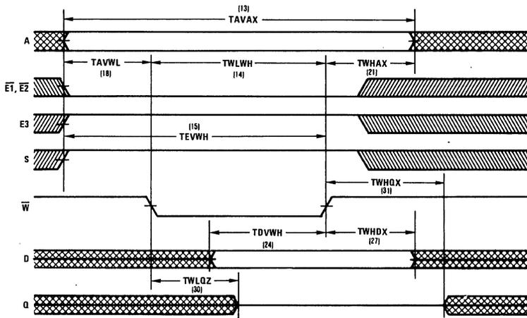
WRITE CYCLE 2:  $\overline{E1}$ ,  $\overline{E2}$ , or  $\overline{E3}$  CONTROLLED (NOTE 2)
