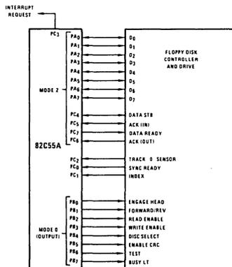
**FIGURE 23. BASIC FLOPPY DISC CONTROLLER INTERFACE**
