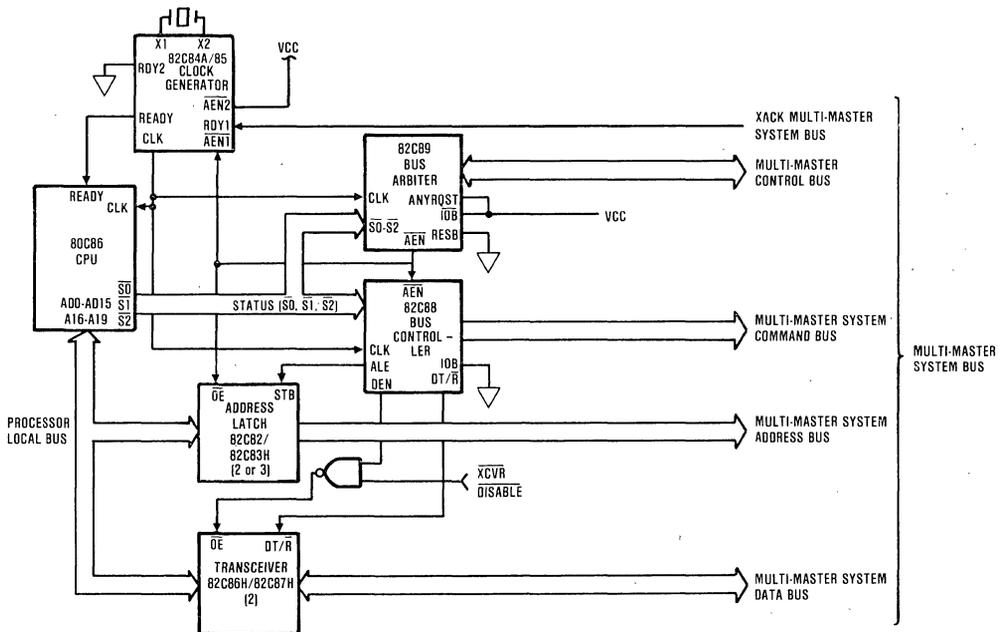
FIGURE 4. TYPICAL MEDIUM COMPLEXITY CPU SYSTEM
