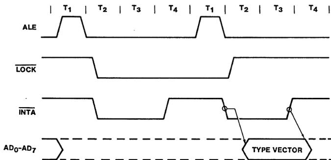
FIGURE 7. INTERRUPT ACKNOWLEDGE SEQUENCE
